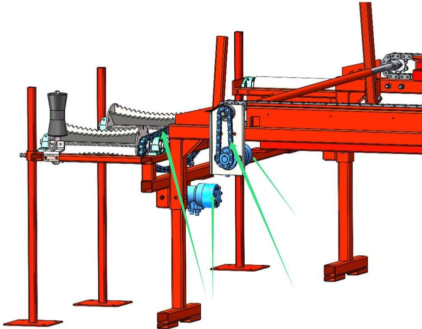
15、 Démarrez le **système hydraulique pour un essai**, en vérifiant les mouvements avant et arrière pour vous assurer que toutes les pièces mobiles fonctionnent en douceur.
