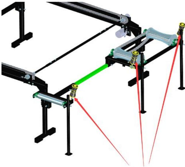
13. Installez les **quatre tubes d'arrêt de bûches**.
