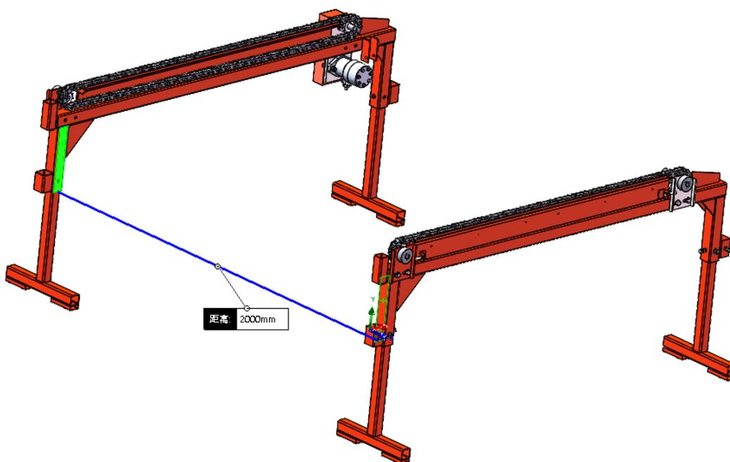
6. Installez la **soudure de tube carré de raccordement** et la **soudure de tuyau de raccordement**. Utilisez **trois tuyaux carrés de 150 cm** pour connecter et soutenir la structure, puis fixez-les solidement.
