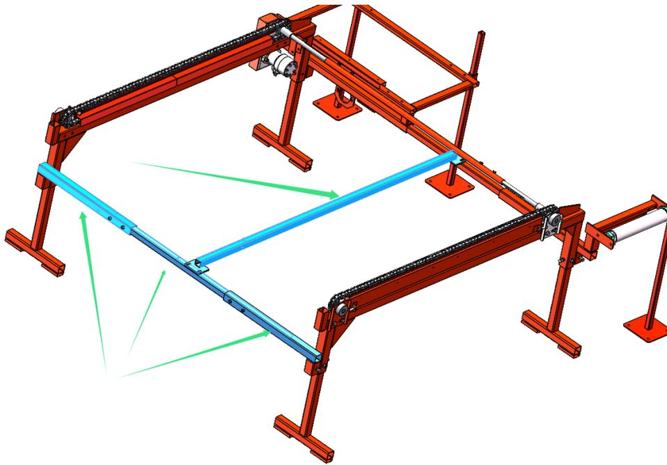
Installez les **tuyaux de raccordement de renfort du milieu**.
