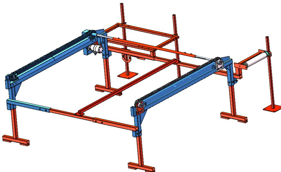
11. Installez **deux ensembles de rouleaux** et fixez la **chaîne de moteur correspondante**, en assurant une prétension appropriée
