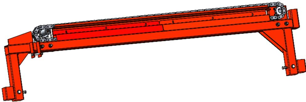
2. Insérez les **pieds de support** comme indiqué sur le schéma, en assurant la même hauteur, et fixez-les avec des boulons.
