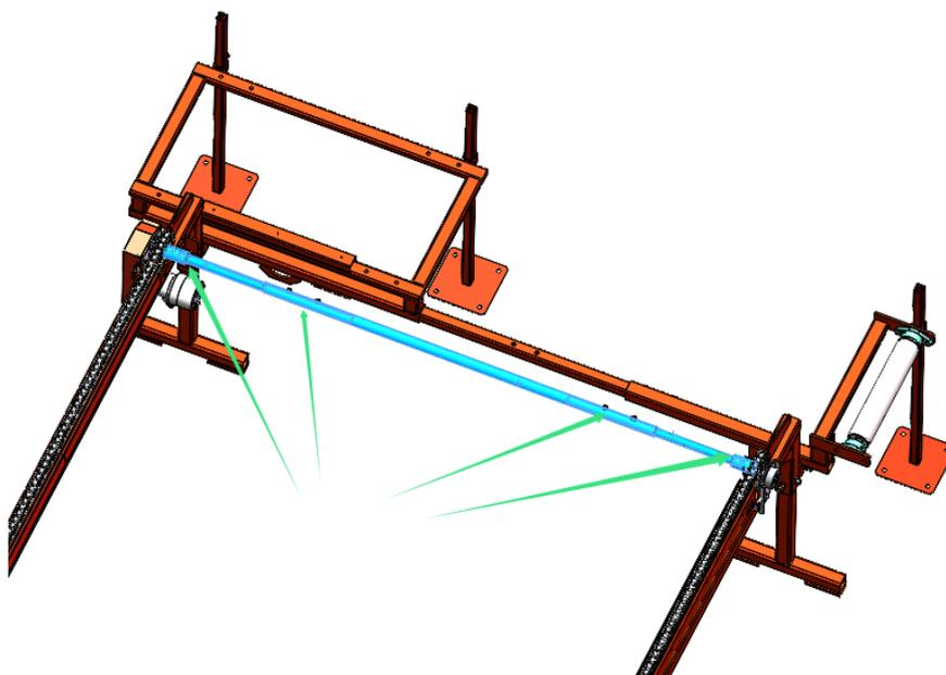
9. Installez les **tubes carrés de raccordement gauche et droit** et utilisez des **tuyaux carrés de 150 cm** pour les connecter et les soutenir. Serrez-les correctement.
